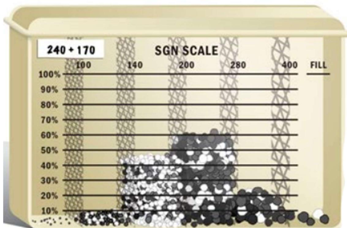
Com este produto, PORTÁTIL e MANUAL, você pode realizar um teste visual e rápido de uma pequena amostra do seu fertilizante, com a finalidade de constatar se ele está dentro do padrão necessário de qualidade granulométrica.
