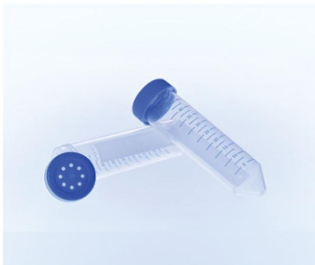
O novo CELLreactor™ pode ser usado como um pequeno biorreator para células em suspensão, facilitando a redução da larga escala de setups. Cada tampa possui 8 orifícios e certificado USP VI, revestida com membrana porosa de 0.2µm, garantindo esterilidade máxima enquanto proporciona excelente troca gasosa. Caso o arejamento precise ser reduzido, as aberturas individuais podem ser seladas. Com design cônico ideal para centrifugação e posterior coleta das células.
